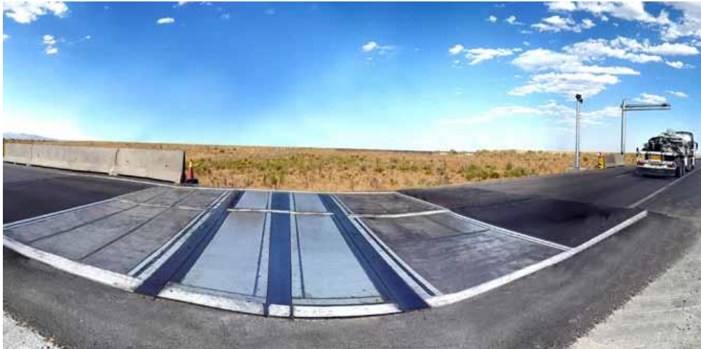
شکل ۲- سامانه توزین در حال حرکت با استفاده از سنسورهای لودسل
