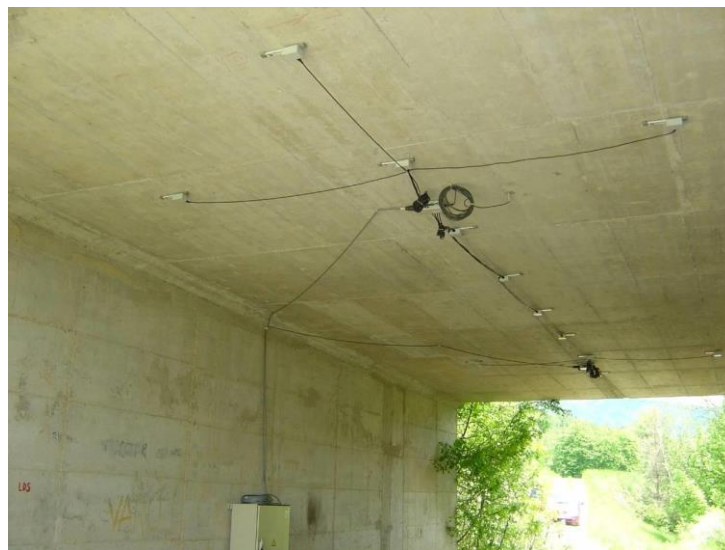
شکل ۱۴- نحوه قرارگیری سنسورهای کرنش سنج در زیر سطح پل (پل رودخانه شور جاده قدیم تهران - قم)
